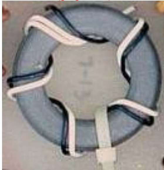
Balun de corriente o Choque RF de Banda Ancha (3 a 30 MHz)
